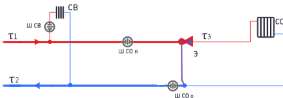
Рисунок 3 – Схема подключения потребителей к двухтрубной тепловой сети (при наличии внутридомовой системы отопления), в качестве регулятора температуры используется элеватор (СО – система отопления, Э – элеватор, СВ – система вентиляции)
